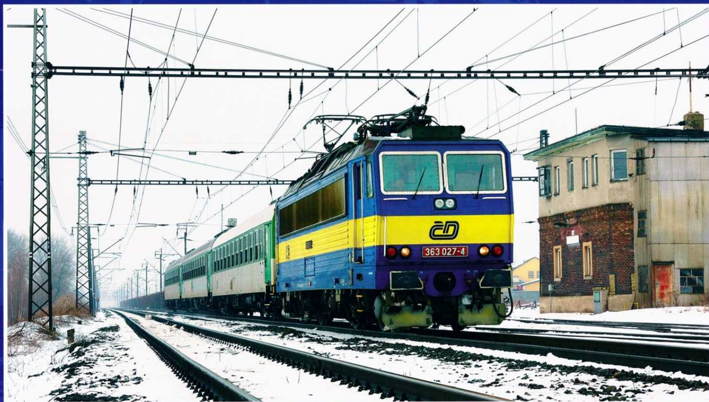
Dvousystémová lokomotiva ES 499.1, dnes značená jako řada 363, projíždí pod přerovským stavidlem č.12.
