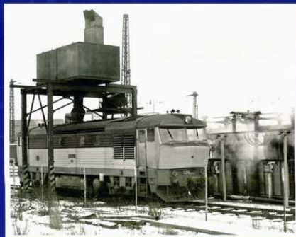
Dieselelektrická lokomotiva řady T478.1 na vodním odporu, 70. léta minulého století.
