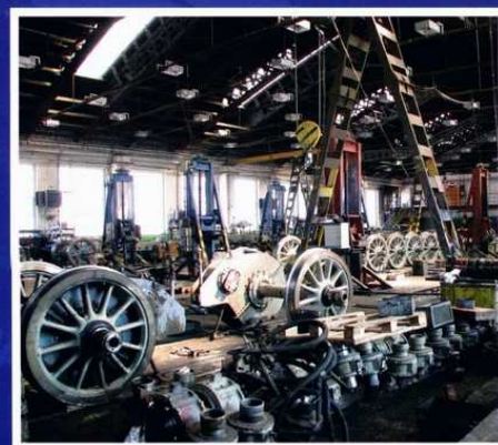
Oprava dvojkolí, Dílny pro opravu vozidel Přerov, 2010.
