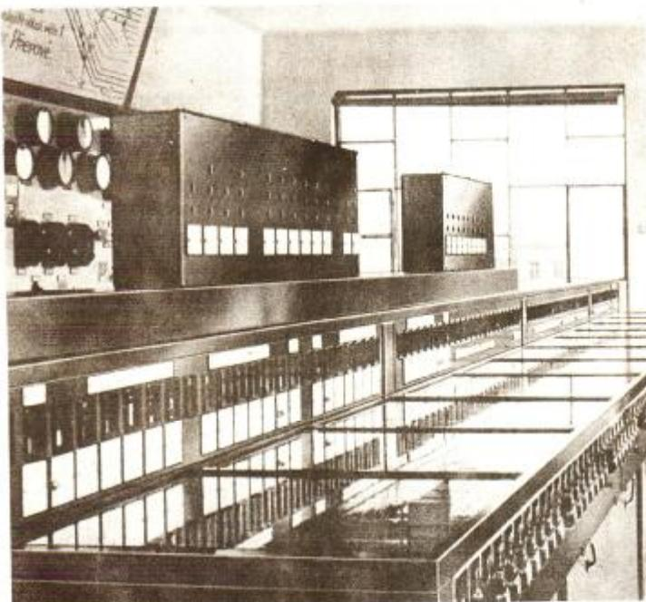
Elektrodynamický stavědlový přístroj na stavědle 1 v Přerově z roku 1934.
